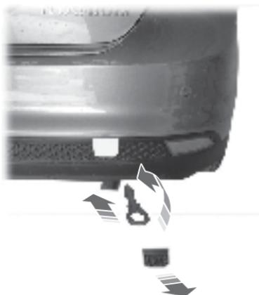
Inserte un objeto adecuado en el orificio de la parte inferior de la cubierta y retire la cubierta haciendo palanca.
