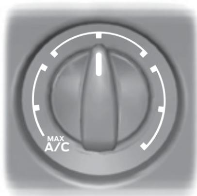
Ajuste para seleccionar la temperatura deseada.
