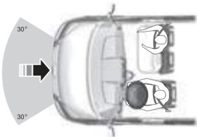
El airbag delanteros se despliegan en colisiones de importancia, ya sean frontales o con un ángulo de impacto de hasta 30 grados a la izquierda o a la derecha. Los airbags se inflan en milésimas de segundo y se desinflan al entrar en contacto con los ocupantes, amortiguando así el desplazamiento del cuerpo hacia delante. En pequeñas colisiones frontales, vuelcos, colisiones traseras y colisiones laterales, los airbags del conductor y del acompañante no se despliegan.
