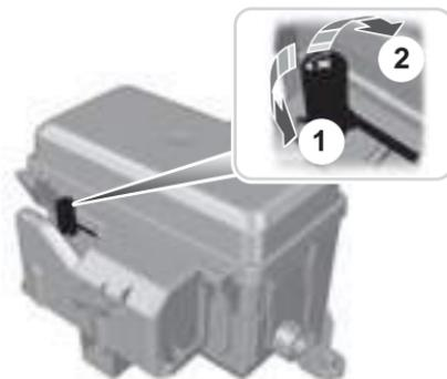
3. Suba la tapa del borne positivo de la batería. Ubicación de componentes: remítase a la visión de conjunto del recinto motor correspondiente. Véase **Mantenimiento**.
