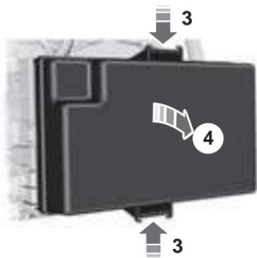
Abra la caja auxiliar presionando las trabas laterales (3) y tirando hacia afuera (4).
