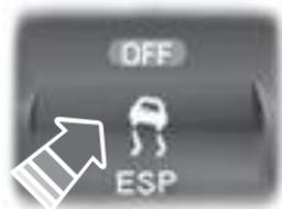
Con una velocidad del vehículo inferior a 60 km/h, mantenga pulsado el interruptor durante un segundo. El interruptor se encenderá.
