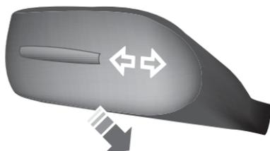
Apriete la palanca hacia el volante para cambiar las luces de bajas a altas y viceversa.
