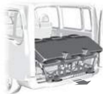
**!** Tape los orificios de tornillos que estén abiertos al retirar los asientos para evitar que los gases de escape entren en el vehículo.
