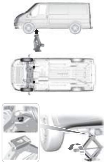
Cierre la tapa de la parte superior del crique (posición de almacenamiento). Los pernos traseros del falso chasis delantero encajan en el rebaje de la tapa del crique.
