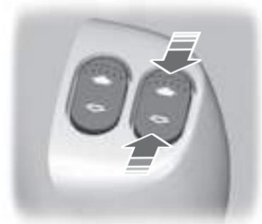
Conecte el encendido para accionar los alzacristales eléctricos.
