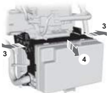
**Nota:** Al volver a montar, asegúrese de escuchar un clic al acoplar las dos abrazaderas.
